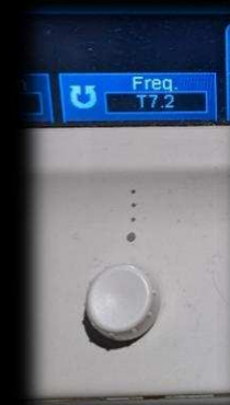
Control de frecuencia de un ecógrafo. En la imagen están seleccionados 7,2 MHz
