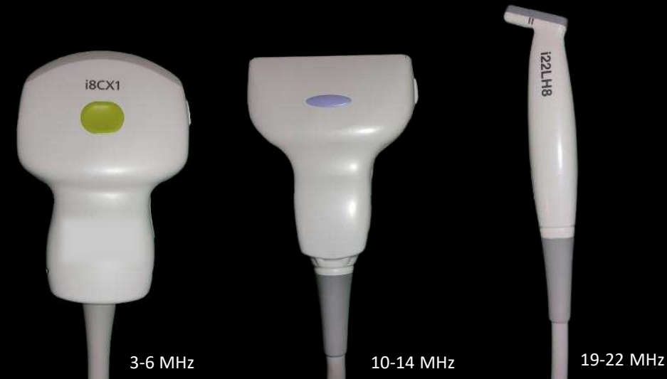
Sondas de ecografía de uso común, con diferentes formatos y frecuencias
