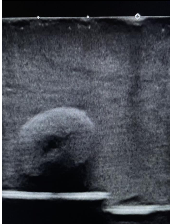
Fig 2. Fantoma 10% agar y 1% maizena Artefactos de reverberación
